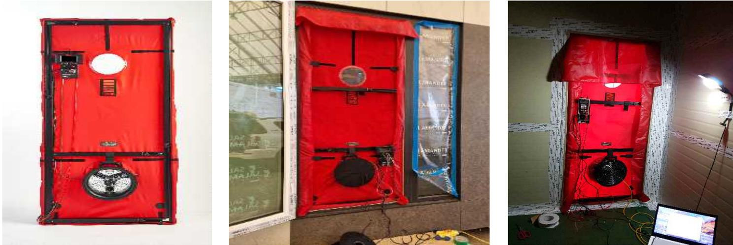
블러도어 MiniFan 측정 시스템은 매우 작은 건물, 개별 아파트 또는 연구 및 실험실 건물(클린룸) 등의 기밀 테스트를 위해 특별히 설계되었습니다. 측정 범위는 5-2,300m<sup>3</sup>/h이며 편리한 측정 팬의 무게는 2.7kg으로 가볍습니다. BlowerDoor 기본측정 장비 측정 범위가 19-8,500m<sup>3</sup>/h@50pa이고 여러 시스템(BlowerDoor MultipleFan)을 결합할 수 있는 BlowerDoor Standard 측정 시스템은 신축 건물 및 기존 건물의 리노베이션에서도 기밀성을 측정하는 데 보편적으로 사용할 수 있습니다. 모든 건물 유형 및 크기에 사용하기에 적합합니다.
